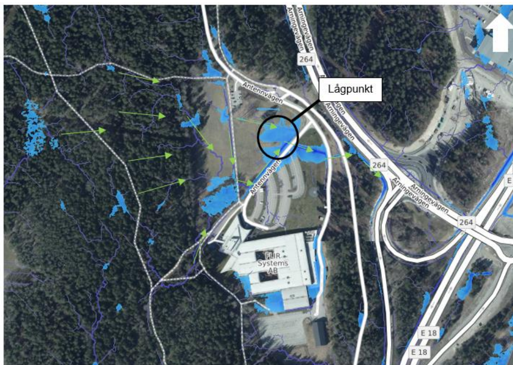
Figur 8-3. Flödesvägar och ansamlingsplatser vid skyfall i blått för nuläge (SCALGO Live). Flödespilar (grönt) visar riktning.
